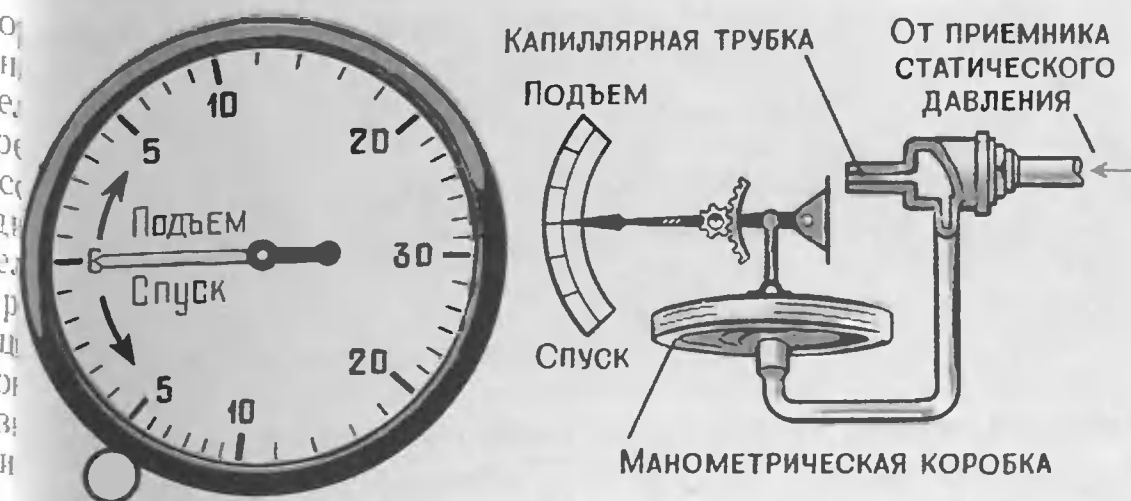
Схема вариометра
