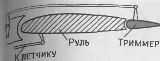
Схема работы триммера
