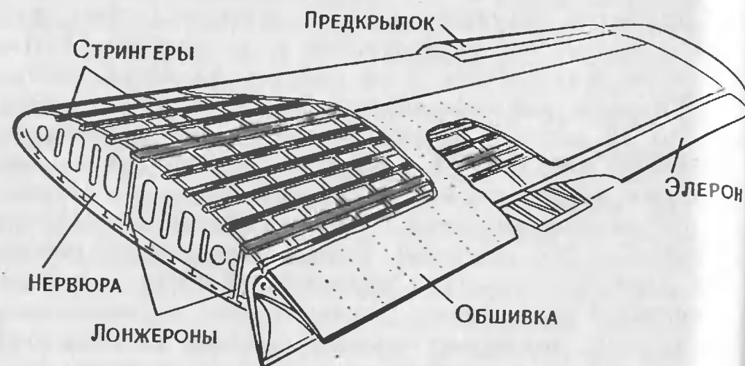
Конструкция крыла
